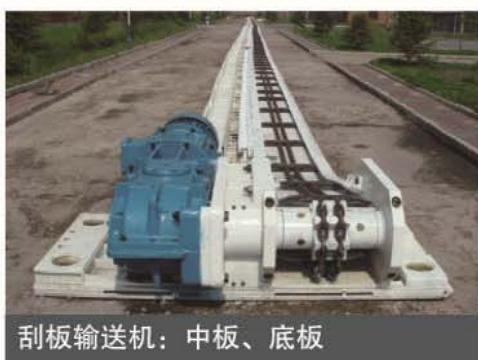
刮板输送机：中板、底板
