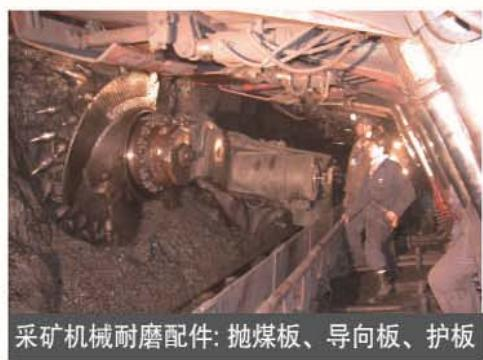
采矿机械耐磨配件：抛煤板、导向板、护板
