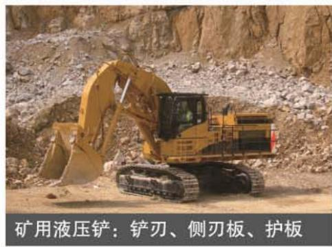
矿用液压铲：铲刃、侧刃板、护板
